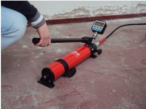
Fase 9: esecuzione della prova ed estrazione del frammento conico
