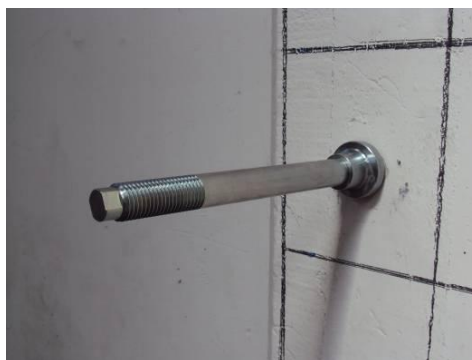
Fase 7: avvitamento dello stelo estrattore del martinetto oleodinamico alla filettatura del tassello
