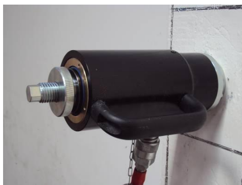
Fase 8: posizionamento e fissaggio del martinetto e collegamento del tubo idraulico alla pompa
