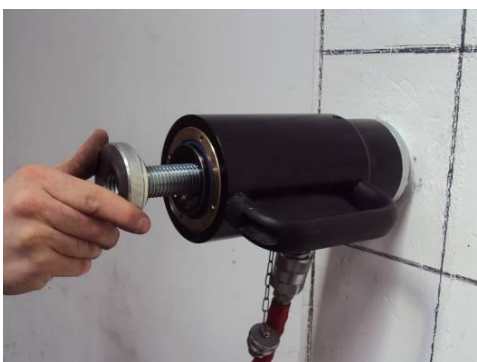
Fase 8: posizionamento e fissaggio del martinetto e collegamento del tubo idraulico alla pompa
