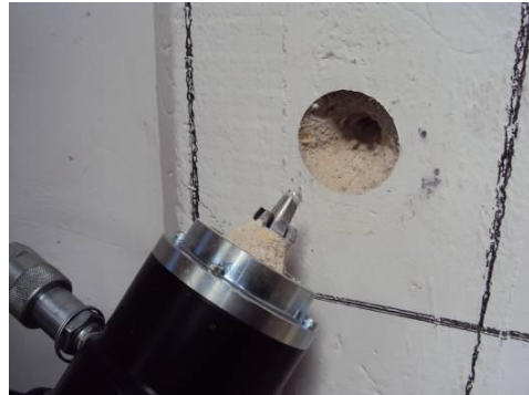
Fase 9: esecuzione della prova ed estrazione del frammento conico
